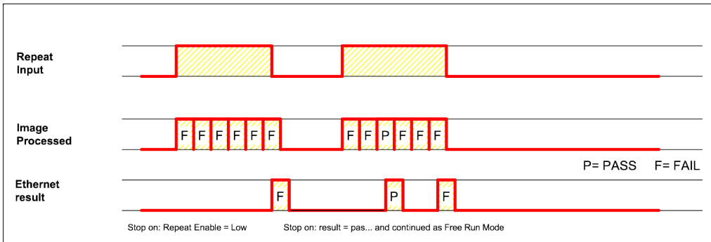
Fig. 292: Input, Repeat Mode Enable, in Freerun
