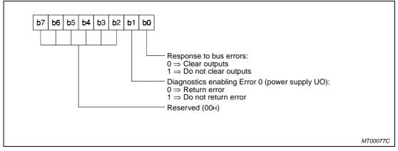
Fig. 7-10: Parameter byte MT-Y8R5 module
