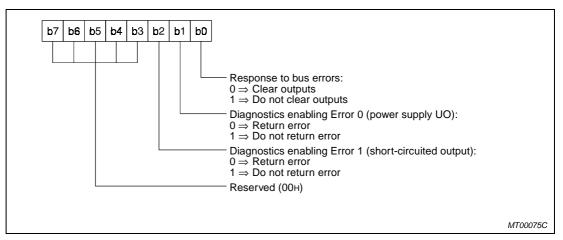
Fig. 7-6: Parameter byte MT-Y8T module
