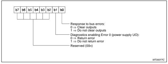
Fig. 7-9: Parameter byte MT-Y4R module
