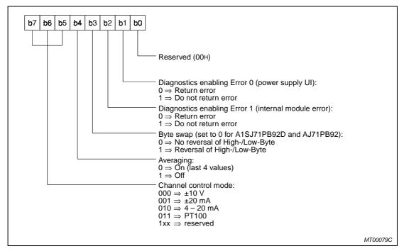
Fig. 7-12 shows the parameter byte arrangement of the MT-4AD-N module:
