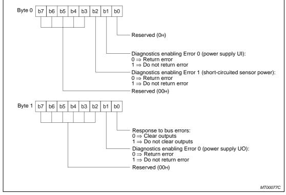
Fig. 7-11: Parameter byte MT-X4Y4T module
