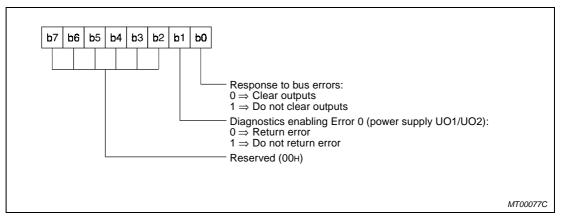
Fig. 7-8: Parameter byte MT-Y8T2 module
