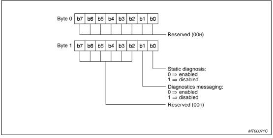
Fig. 7-1: Parameter byte MT-DP12 module
