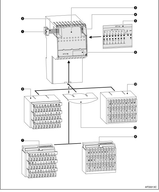
Fig. 4-9: Digital input module MT-X16
