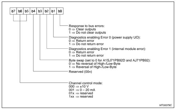
Fig. 7-14: Parameter byte MT-4DA module
