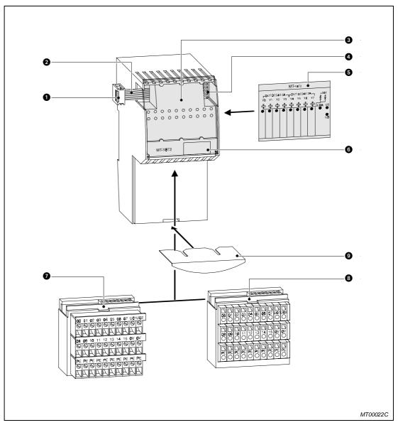
Fig. 4-18: Digital output module MT-Y8T2
