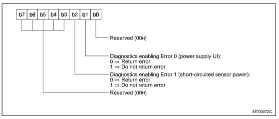
Fig. 7-3: Parameter byte MT-X8 module
