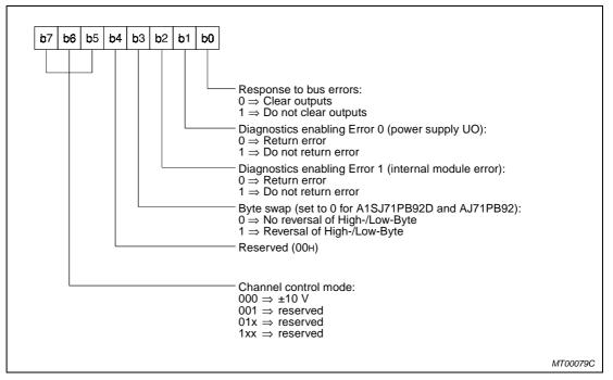
Fig. 7-13: Parameter byte MT-4DAV module
