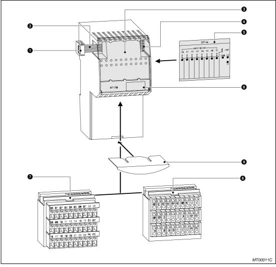
Fig. 4-7: Digital input module MT-X8
