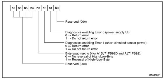
Fig. 7-5 shows the parameter byte arrangement of the MT-X16 module:
